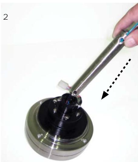
**ESP** Retire el pasador de seguridad. Pase los cables a través de la tija.
