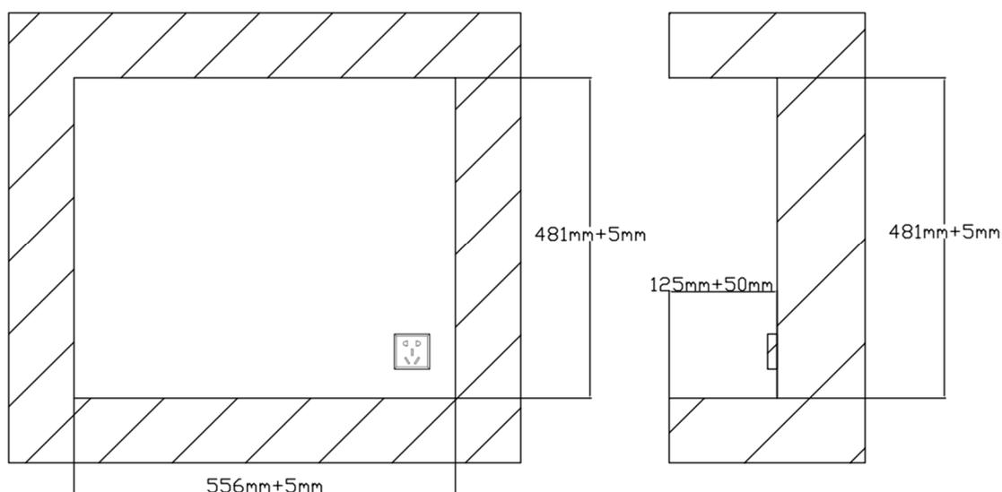
**HINWEIS:** Die genauen Abmessungen des Schrankes oder der Wandöffnung, in die der Kamin eingebaut werden soll, sind: Breite 584 x Höhe 495 (mm). Es wird empfohlen, bei der Planung der Öffnung eine Toleranz von +3 mm für die Breite und die Höhe zu berücksichtigen.
